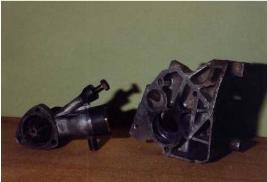
Reparatur einer KFZ-Wasserpumpe mittels MM-metall SS-Stahl, flüssig mit Härter gelb, flüssig.
