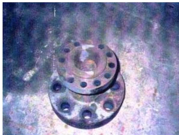
Reparatur von Gasdruckausgleichsventilen. Der Verschleiß trat durch austretendes Gas (193 bar) und mitgeführte Verunreinigungen wie z.B. Sand auf. Die Reparatur wurde mit Ceramium durchgeführt. Bei einer späteren Kontrolluntersuchung wurden keinerlei Beanstandungen festgestellt.
