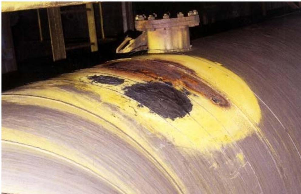
Korrodierte Gasleitungen, entstanden durch Undichtigkeiten eines Hochofens, wurden repariert mit Ceramium, pastös und Härter CE.
