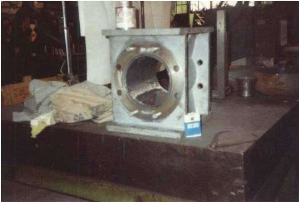
Der obere Teil eines Pumpenflügelrades zur Abfüllung von fertigem Zement in Säcke war starkem Verschleiß durch Abtragung und Abnutzung ausgesetzt. Zwischenzeitlich wurde versucht, die Wiederherstellung durch Auftragsschweißen herbeizuführen. Die endgültige Instandsetzung wurde mit Ceramium pastös und Härter CE durchgeführt.
