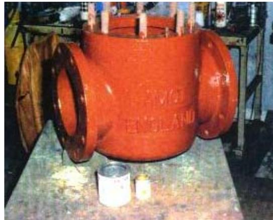
Instandsetzung eines Dreiwegeventilgehäuses für Seewasser. Material: GG, Schaden: erhebliche Auswaschungen sowie ein klaffendes Loch im Ventilgehäuse. Die Reparatur wurde mit MM-metall SS-StahlKeramik und Härter gelb sowie Ceramium, flüssig und Härter CE durchgeführt.
