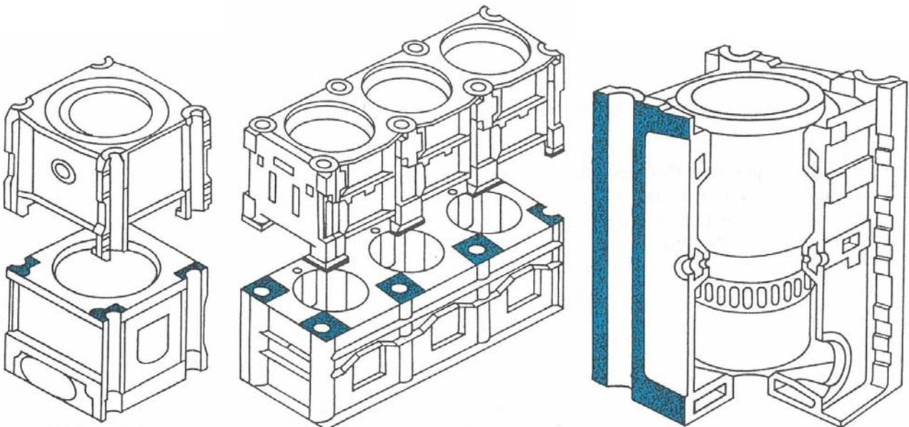
Sanierung von Zylinderblöcken und Auflageflächen großer Schiffsdieselmotoren mit MM-metall SS-StahlKeramik. Nötig war die Reparatur aufgrund von großem Verschleiß zwischen Zylinderblöcken und Auflageflächen besonders im Bereich des Spülluftkastens. Für diese Art der Instandsetzung empfiehlt der Motorenhersteller ausschließlich die Verwendung von MM-metall SS-StahlKeramik mit Härter grün.
