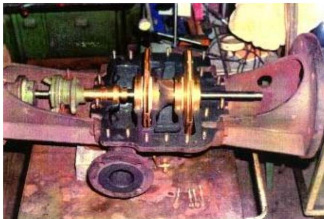
Instandsetzung mehrerer Not-Lenz- und Feuerlöschpumpen (Typ Loewe VZLG 65/1/2, Leistung 60 m<sup>3</sup>/h) mit Ceramium, pastös und Ceramium, flüssig. Bei einer Inspektion 3 Jahre nach Instandsetzung wurden keine Beanstandungen der Reparaturstelle festgestellt.
